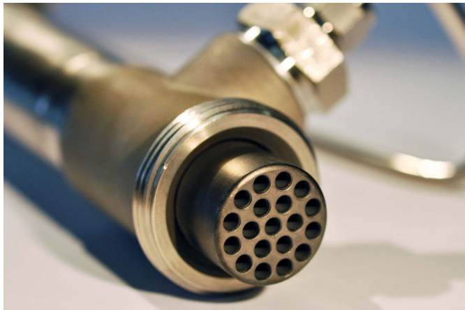
Abb. 1 Die insgesamt 19 Kanäle in der Kohlenstoff-Membran vergrößern deren Oberfläche und ermöglichen somit einen größeren Stoffdurchsatz.
