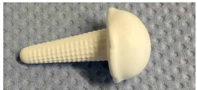
Gegossenes patientenspezifisches Fingergelenksimplantat aus ATZ.
