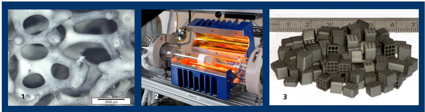
1 Zellulare Makrostruktur eines Füllkörpers.
