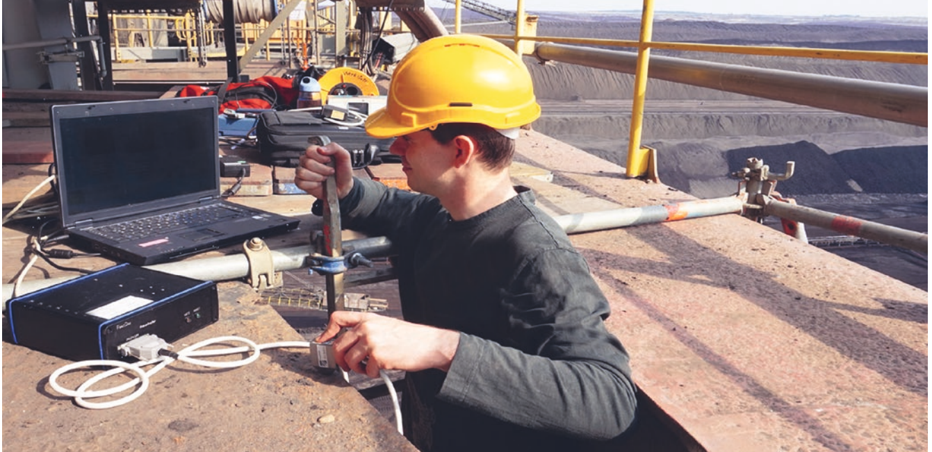
Schweißnahtprüfung an Tragwerksstrukturen mittels mikromagnetischem Barkhausenrauschen.
