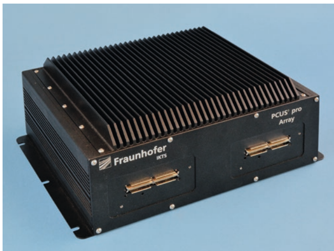
PCUS® pro Array II: Kompakte Elektronik mit 128 parallelen Kanälen für die automatisierte Ultraschallprüfung.
