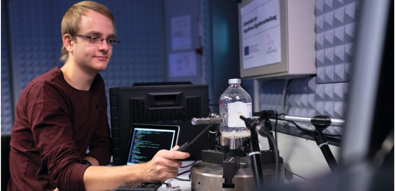
Rissprüfung an Glasflaschen mit Hilfe der akustischen Resonanzanalyse.
