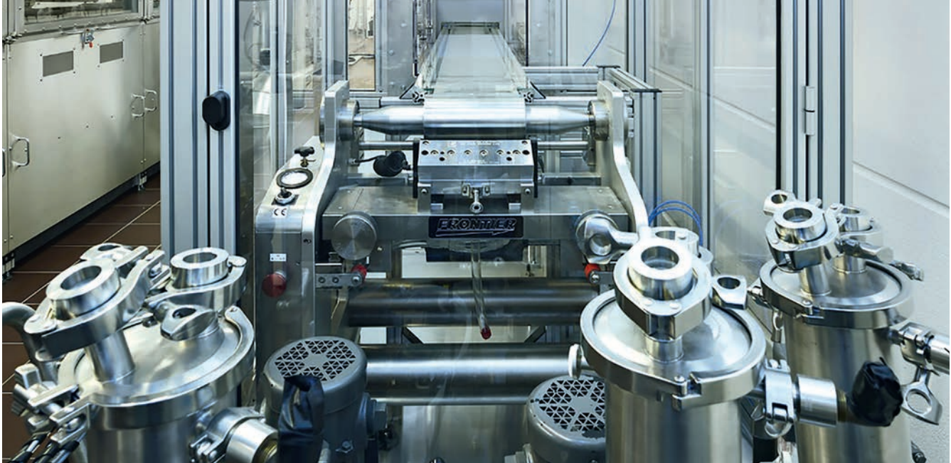
Technologieentwicklung für Mehrfachbeschichtung mittels Triple-Slot-Die-Coating.
