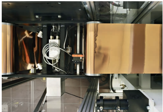
VaLiBat-Coater für die Herstellung von Batterieelektroden.
