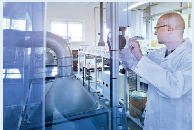
Slot-Die-Coater im Foliengießzentrum am Standort Hermsdorf.
