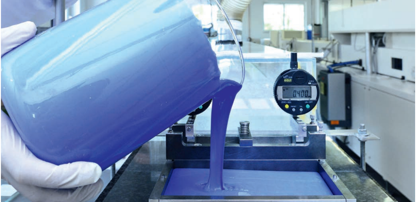
Dosierung des Schlickers in den Gießkasten.
