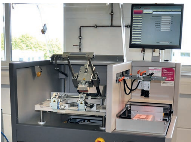
Siebdrucker EKRA-M2H zur Folien-Funktionalisierung.
