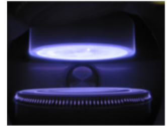
PECVD-Prozessierung von Kohlenstoffnanoröhren.
