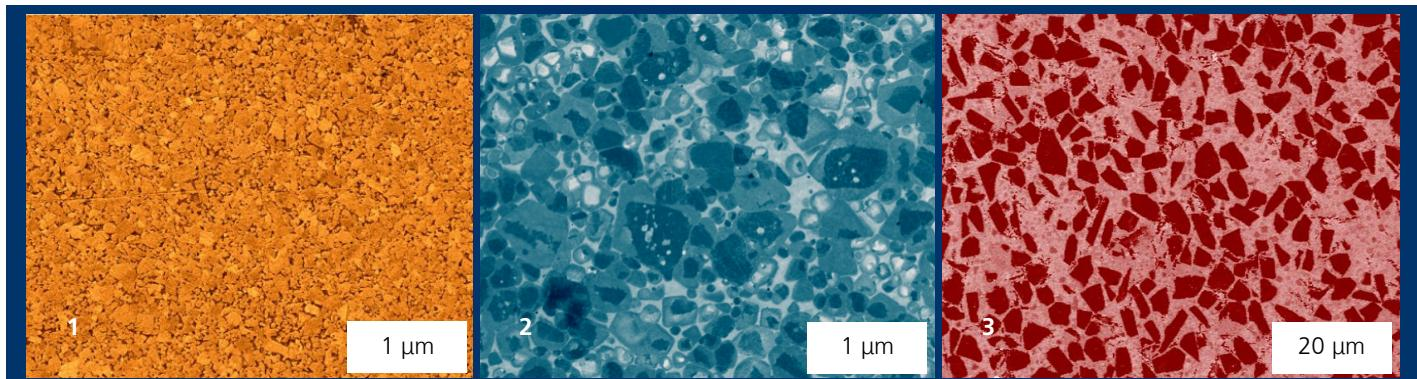
1 Gefüge eines nanoskaligen Hartmetalls.
