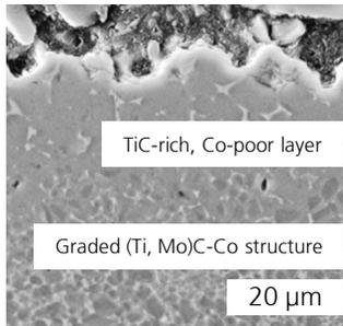
Gradiertes (Ti,Mo)C-Co Hartmetall (1).
