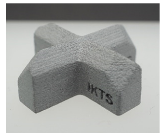
Gesintertes Bohrkopf mit Prägung.
