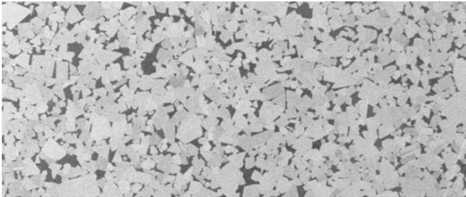
*Gefüge eines 3D-FFF-gedruckten Hartmetalls der Zusammensetzung WC-9-Ni.*
