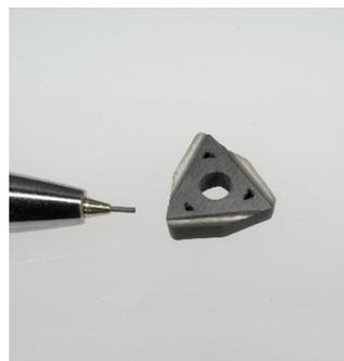
*FFF-gedruckte Hartmetallwendescheidplatte mit Spanbrechergeometrie.*
