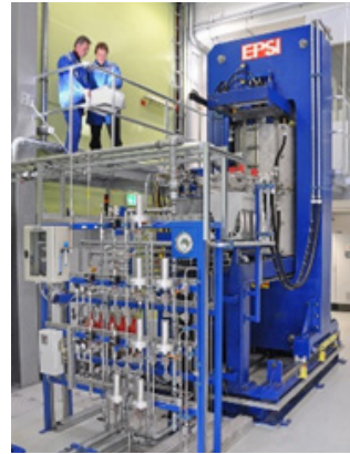
Heißisostatische Presse (Ø 300 mm x 450 mm).
