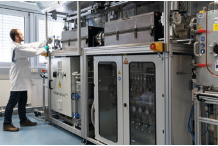
Rolle-zu-Rolle-CVD-Beschichtungsanlage für die kontinuierliche Faserbeschichtung.
