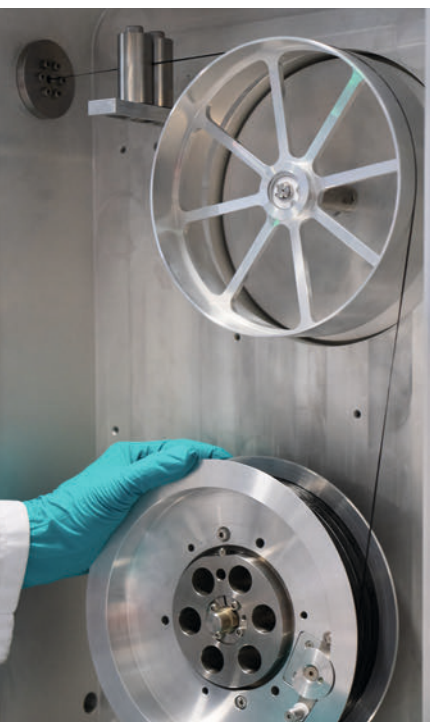
Wickelwerk mit beschichtetem, aufgewickeltem Faser-Roving.
