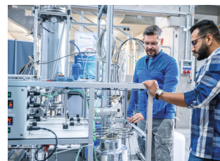
Abb. 2: Aufbau Teilanlage Membranreaktor. (Quelle: Timo Lutz | Team für Industriefotografie).
