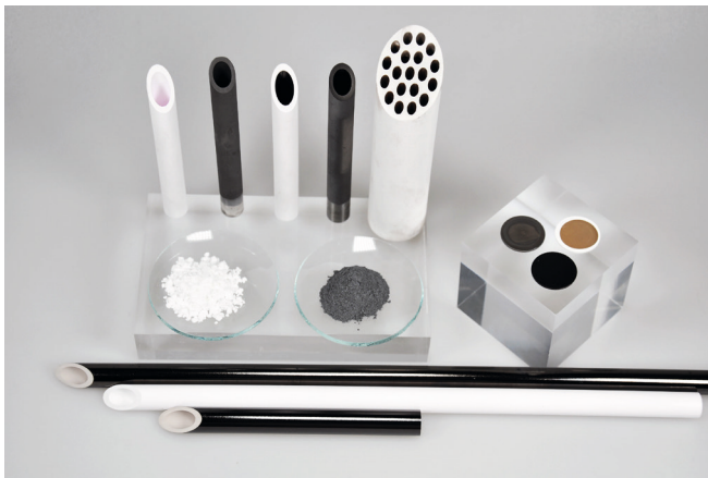
Abb. 1: Kohlenstoffmembranen des Fraunhofer IKTS auf verschiedenen, keramischen Trägern.
