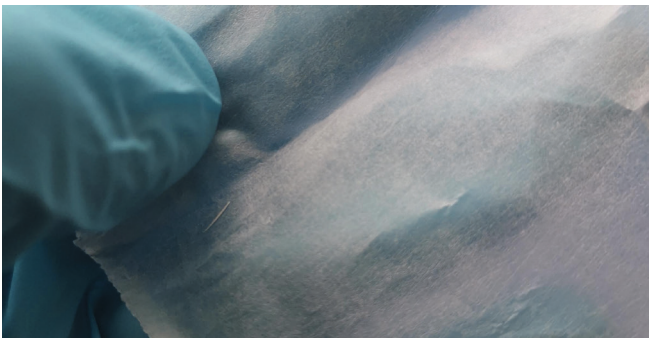
Abb. 1: Elektrogesponnene, bioabbaubare Membran.
