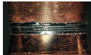
Abb. 3: Zug-Druck-Probe mit Diffusionslotverbindung.
