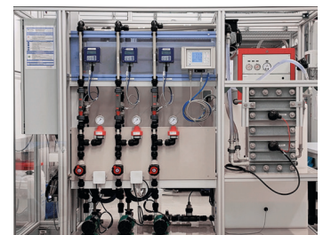
Abb. 3: Pilotanlage Elektrodialyse zur Metall-Aufreinigung (160 l).
