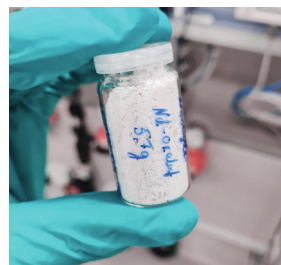
Abb. 2: Zurückgewonnenes Nd-oxalat mit 95 %-Reinheit.
