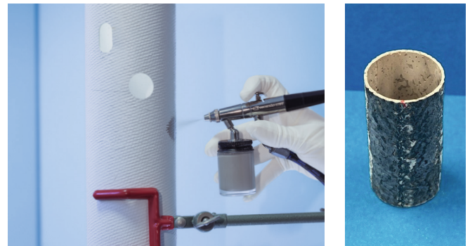
Abb. 1: Herstellung gasdichter oxidischer Faserkeramik (OCMC) am Beispiel von Rohren: Suspensionsauftrag (links), Rohr nach Laserbearbeitung (rechts).
