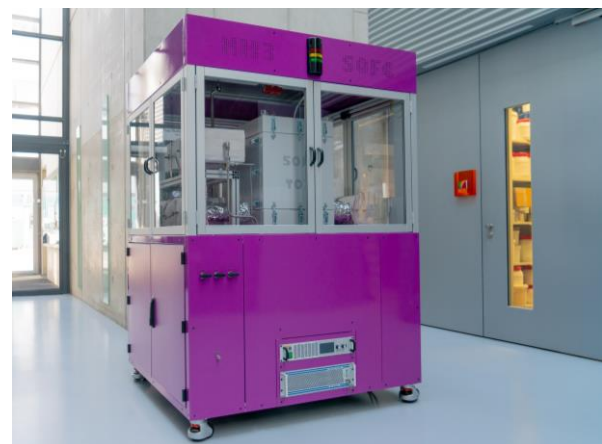
Bild 3: NH 3 -SOFC - Demonstrationsanlage.
