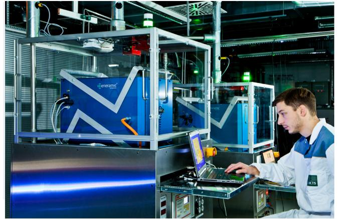
*Automatisierter Teststand für Brennstoffzellen, welcher auch Elektrolysezellen nach dem »EU harmonized protocols for testing of low-temperature water electrolysis« charakterisieren kann.*
