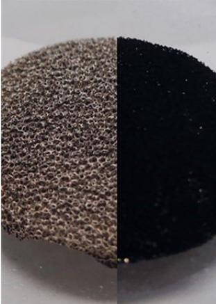
*Keramik-beschichtete Elektrode für alkalische Energiewandler, z. B. als Gasdiffusionselektrode.*
