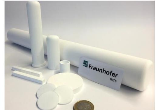
Abb. 4 Verschieden geformte Elektrolyte aus Na-β"-Aluminat.
