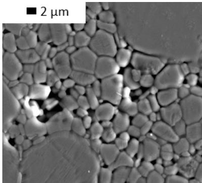
Abb. 2 REM-Aufnahme des Gefüges eines Na-β"-Aluminat Elektrolyten.
