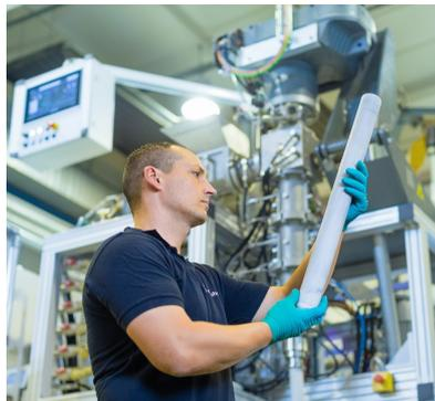
Abb. 3 Elektrolytrohr aus Na-β"-Aluminat vor der Sinterung.
