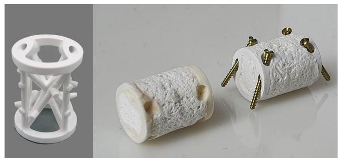
*Hybrid-Bone-Testimplantat: Innere CerAM VPP-Stützstreben (TCP:ZrO<sub>2</sub>; links) und ausfüllender Gefrierschaum (TCP).*
