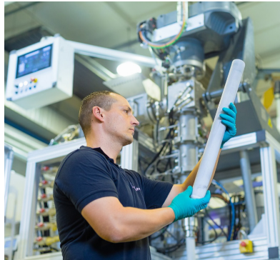
Abb. 2: Elektrolytrohr aus Na-β"-Aluminat vor der Sinterung.
