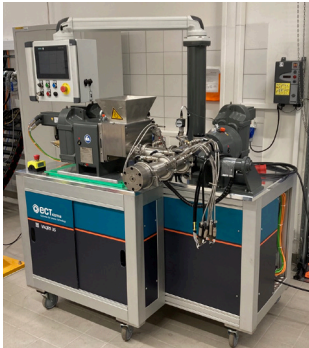
Abb. 1: VAQRS 35 Extruder für Elektrodenextrusion.
