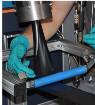
Abb. 2: LFP Elektrode (IBUvolt® LFP), beim Austreten aus dem Extrudermundstück.
