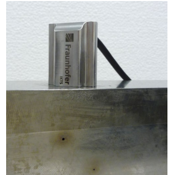
Prüfkopf auf Titantestkörper.
