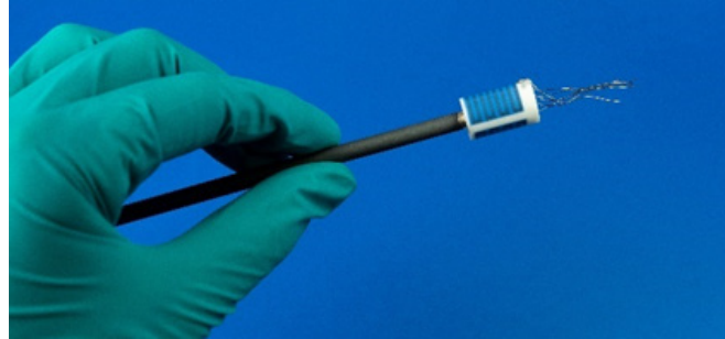
Additiv gefertigte Referenztemperaturstelle zur Aufnahme keramischer Thermoelemente mit integrierter Temperaturmessung.
