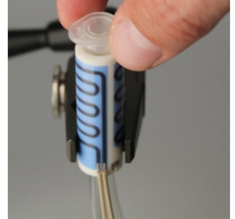
Funktionalisiertes PCR-Testmodul mit integrierten Heiz- und Kühlstrukturen.
