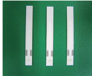
Temperatursensor in HTCC-Multilayertechnologie.
