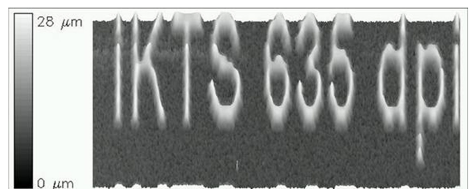
Inkjetdruck einer Ag-Tinte auf Si-Wafer.
