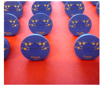
Massentaugliche Herstellung der Drucksensoren.
