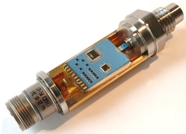
Druck/Temperatur-Kombisensor mit integrierter Elektronik.
