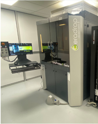
Multi-Material-Drucker mit Inline-Trocknung und Sinterung.
