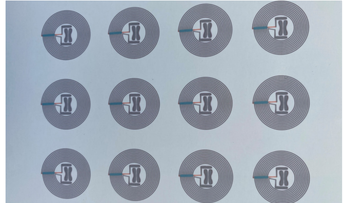
Gedruckte Funktionsschichten in der Elektronik: Spulenarray im Inkjet-Mehrlagendruck (in Kooperation mit J.A.M.E.S GmbH).
