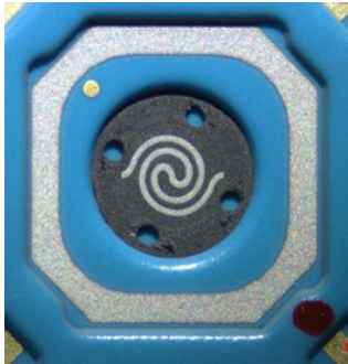
Monolithischer keramischer IR-Emitter mit Keramikmembran hoher Emissivität.
