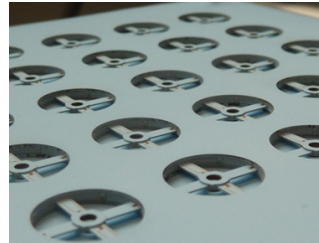
Fertigung im Nutzen: 25 Sensoren je 4 Zoll-Substrat.
