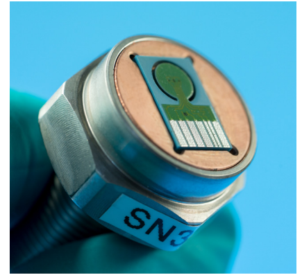
Gefügter LTCC-Drucksensor im metallischen Druckanschluss.
