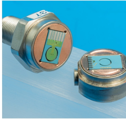
In metallischen Druckanschluss assemblierte LTCC-Drucksensoren.
