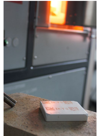
Temperaturstabile Kennzeichnung nach 1.300 °C.
