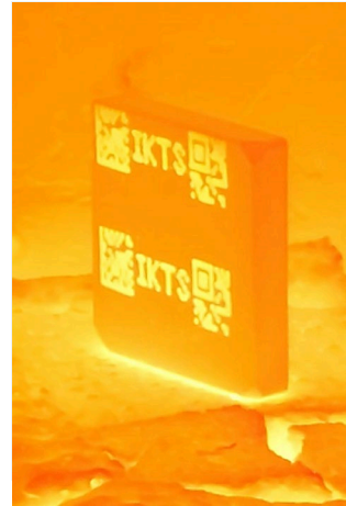
Temperaturstabile Kennzeichnung bei ca. 1.100 °C.
