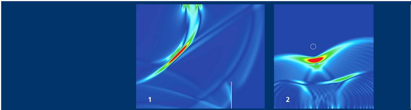
1 Schallfeld eines Ultraschall-Winkelprüfkopfs.
