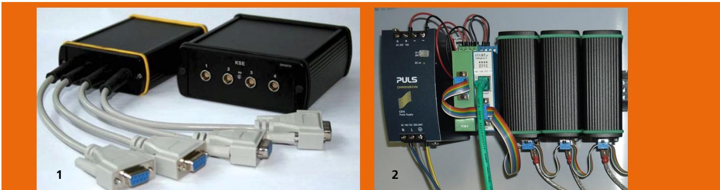
1 Mehrkanaliges Akustisches Messsystem (DMAS02-NF).
