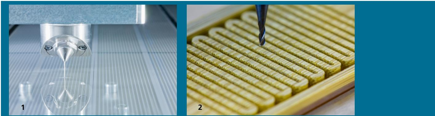
1 Herstellung piezokeramischer Fasern durch Faserspinntechnik.
