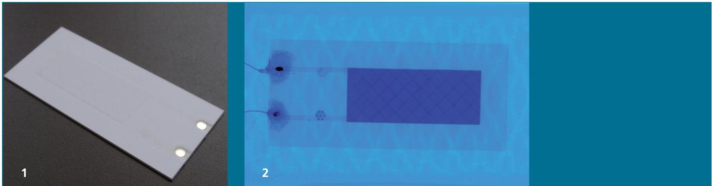
1 Keramisches Sensor-Aktor-Modul mit integrierter piezoelektrischer Platte und innerer elektrischer Verdrahtung.
