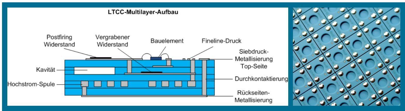
1 Schema für LTCC-Multilayer-Aufbau.
