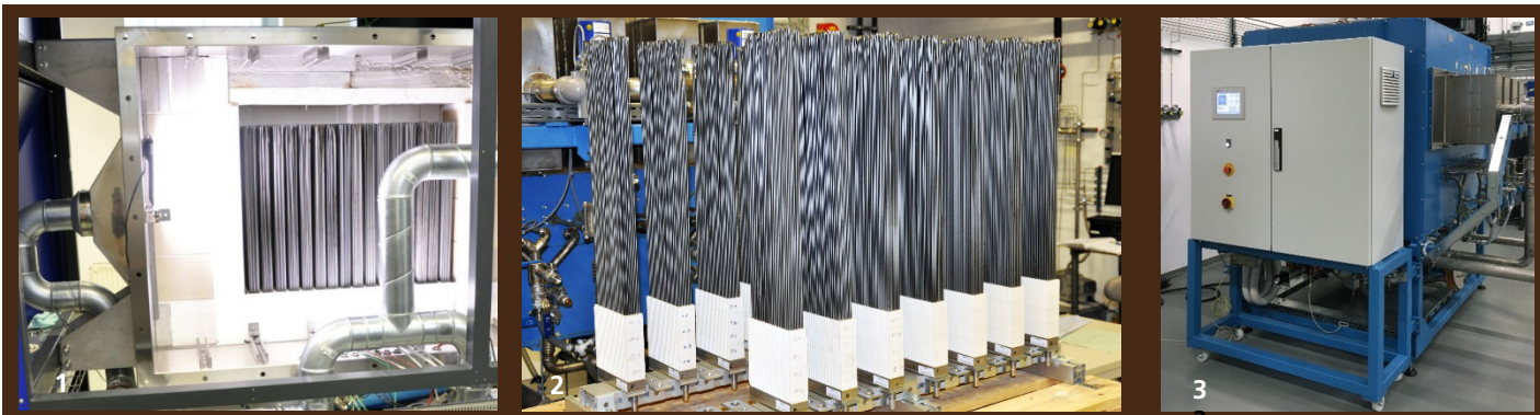
1 Prozesskammer des poXos®-Generators.
