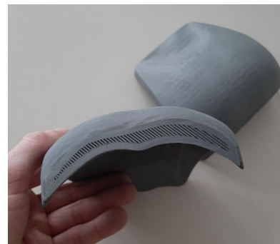
Skalierter doppelwandiger SiSiC Brustpanzer gefertigt über Fused Filament Fabrication (CerAM FFF).
