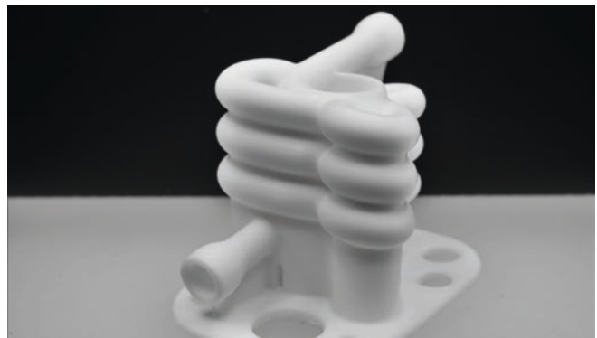
Bild 2: Frontansicht des Tesla-Ventils mit Einlass für Gegenströmung im Vordergrund.
