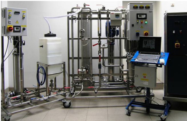
Filtrationsanlage VSA IKTS mit Filterflächen von 0,1 m 2 bis 2,6 m 2 , mit PID-Regelung, Rückspüleinheit, Datenlog.
